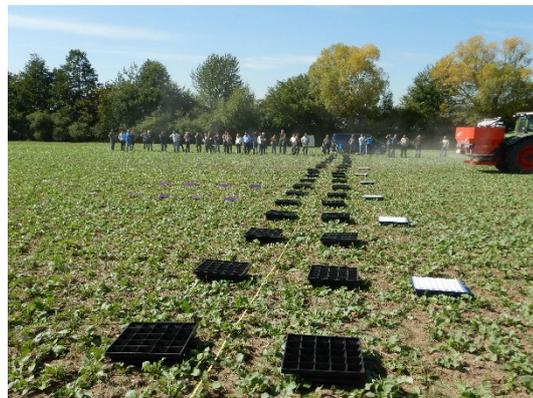
Abbildung 2: Aufgestellte Streuschalen zur Ermittlung der Querverteilung
